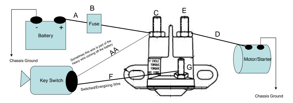
Note: Do not remove nut from stud (C) or stud (E).
