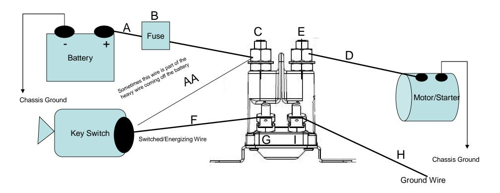
Note: Do not remove lower nut from stud (C) or stud (E).
